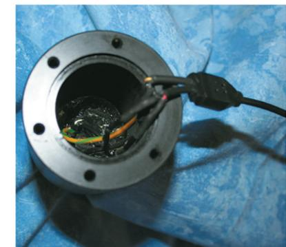
Die Verschraubung nun fest verschließen - nein, nicht abreißen. Die Verschraubung von Innen mit Zwei-Komponenten-Kleber auffüllen. Es sollte ruhig etwas mehr sein und den Boden des Gehäuses leicht bedecken.
